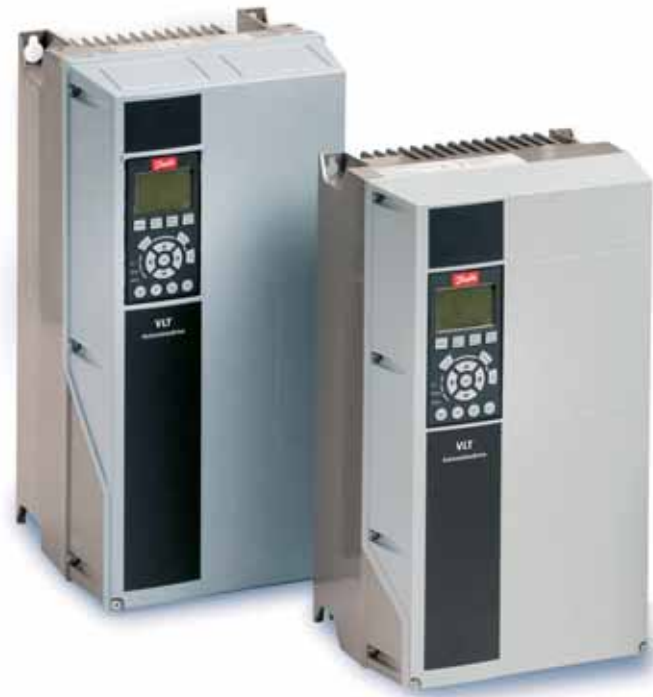
IP55/66 외함의 FC300 드라이브. EMC 필터나 DC 쇼크등의 모든 부품이 내장되어있습니다. 케이블은 하부로 인입됩니다.
